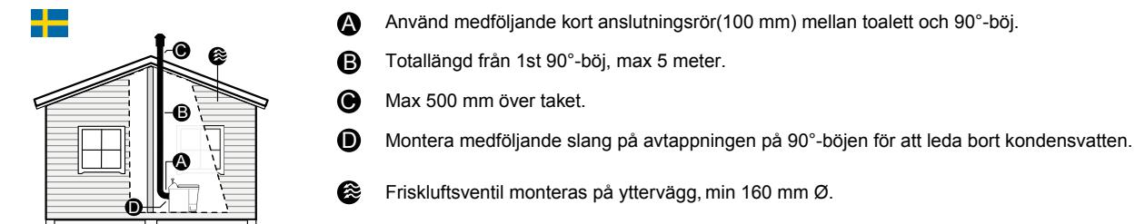
**OBS!** Endast Ø110 mm ventilationsrör i plast och 1st 90°-böj får användas vid installationen.
