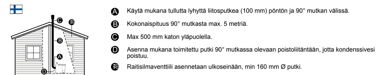
**HUOMI!** Tuuletusputkistossa saa käyttää ainoastaan Ø110 mm muovista tuuletusputkea asennuksessa saa olla ainoastaan yksi 90° mutkaputki.
